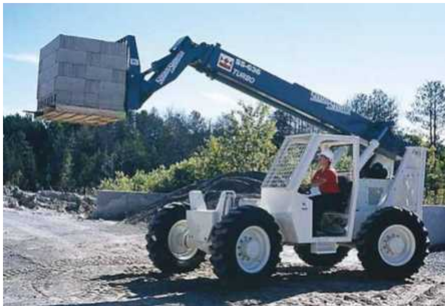
Slika 3. Viljuškar sa teleskopskim mehanizmom za rukovanje teretom
